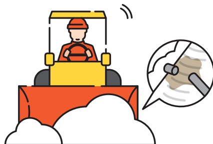
除雪の際に配管が 破損したことによる漏えい
